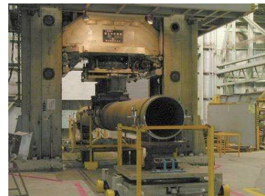
写真2 曲げ試験状況
